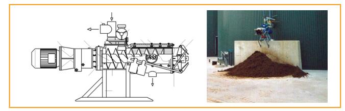
Figure 3.35: Screw separator [FAN Separator GmbH (left); PlanET Biogastechnik GmbH]
