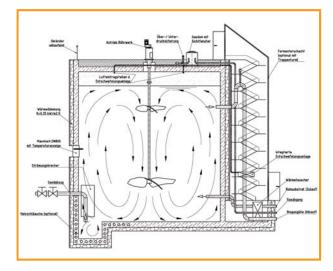
*Figure 3.33: Axial agitator [ENTEC Environmental Technology Umwelttechnik GmbH]*
